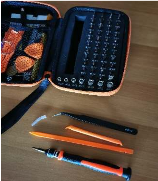
Tipici pry tools, utilizzare solo punte in plastica!
